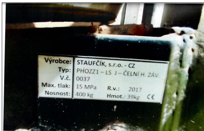
Foto č. 3 Štítek čelního hydraulického závěsu – STAUFČÍK, s.r.o., v. č. 0037, r. v. 2017, nosnost 400 kg
