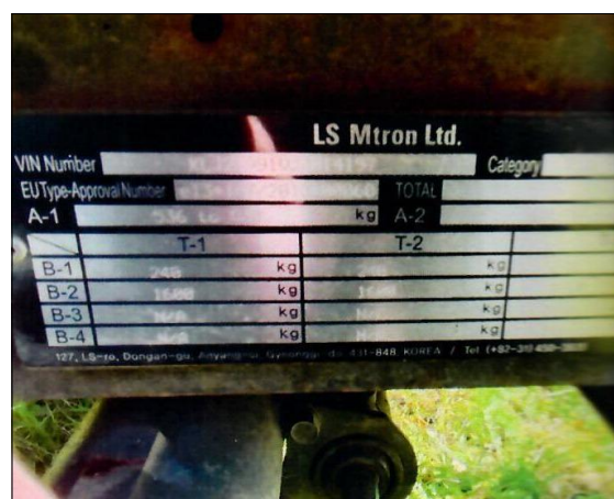
Foto č. 18 Výrobní štítek traktoru LS Mtron Ltd. (VIN, schválení typu, hmotnosti)
